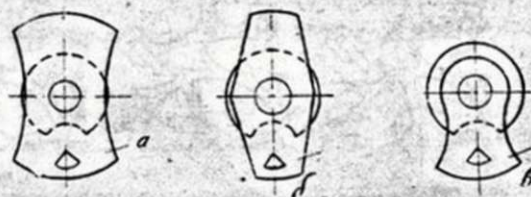
Фиг. 83. Импулсни ролки с некръгли форми
