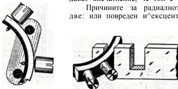
Фиг. 248. Инструмент за кзправене на баланса при радиално биене
