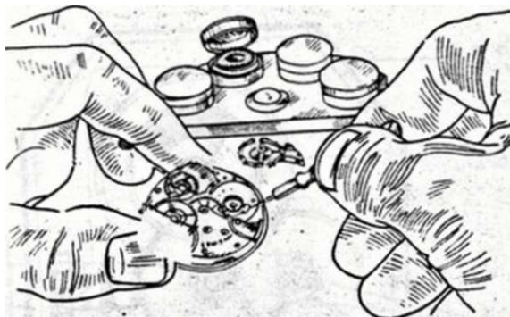
Фиг. 163. Начин на смазване
