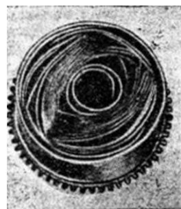
Фиг. 181. Счупена пружина вследствие корозия (ръжда)
