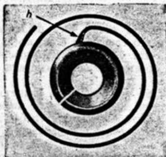
Фиг. 269. Огънатата част на спиралата излиза извън отвора -
