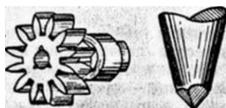
Фиг. 191. Затягане на минутния пињон чрез триъгълен пробой
